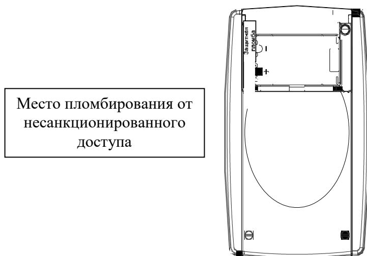
Рисунок 1 - Схема пломбирования от несанкционированного доступа
