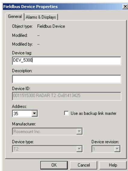
4. В окне Fieldbus Device Properties (свойства устройства Fieldbus) можно ввести метку и описание устройства. Данная информация не требуется для работы уровнемера и ее можно пропустить при желании.
