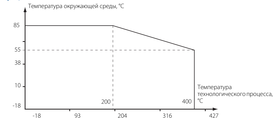
Рисунок 3-10. Отношение максимальной температуры окружающего воздуха к температуре процесса
