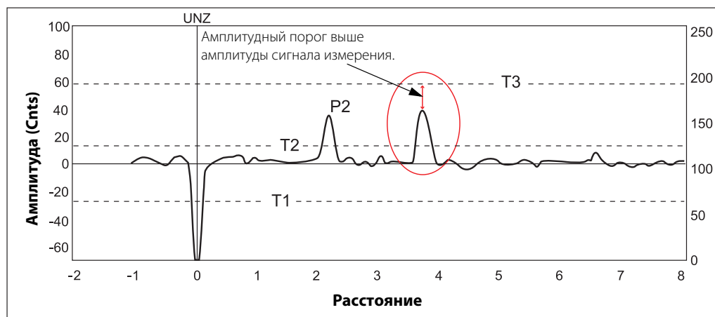
Рисунок 6-4. График эхосигнала с указанием того, что амплитудный порог для эхосигнала поверхности границы раздела сред слишком высок
