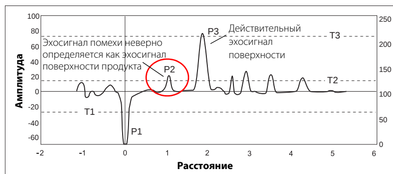
Рисунок 6-11. Пример 2: амплитудный порог T2 установлен слишком низко
