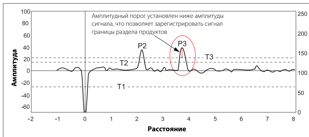
Рисунок 6-5. После изменения амплитудного порога уровнемер регистрирует эхосигнал границы раздела
