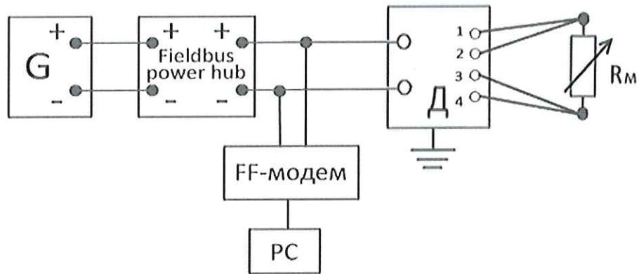
FF-модем – Преобразователь интерфейса Fieldbus – USB для связи преобразователя с компьютером.
