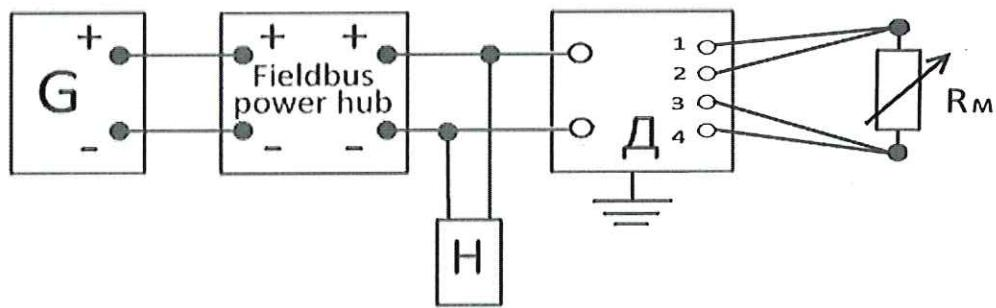
Fieldbus power hub – Распределительная коробка для сегмента шины Foundation Fieldbus;
