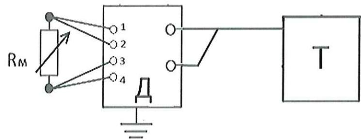
$T$  – коммуникатор Trex с расширенным модулем подключения к полевым устройствам для связи с преобразователем по цифровому каналу и для обмена данными по протоколам HART, Foundation Fieldbus.
