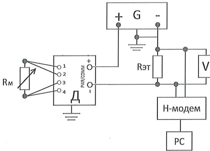
Н-модем – HART–USB модем, указанный в табл. 1, для связи преобразователя с компьютером;
