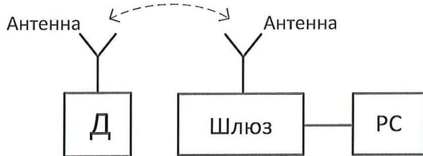
Шлюз – Устройство для беспроводной связи с преобразователем по цифровому каналу WirelessHART (например, беспроводной шлюз 1420, указанный в табл.2);
