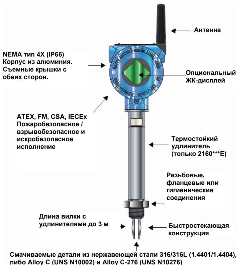
Рисунок 1-1. Функциональные элементы сигнализатора серии 2160
