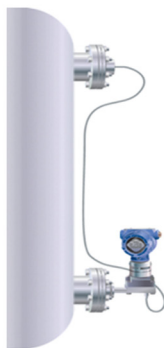
Система Tuned System (длины капилляров не равны)
