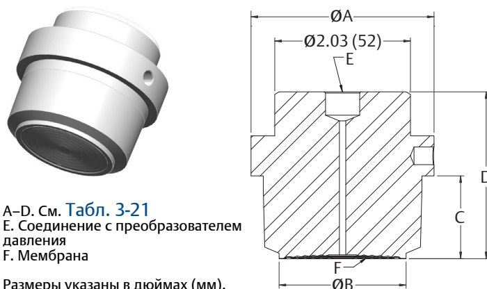
Рисунок 3-17. Разделительная мембрана HTS с наружной резьбой
