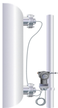
Сбалансированная система (одинаковая длина капилляров и тип мембраны)
