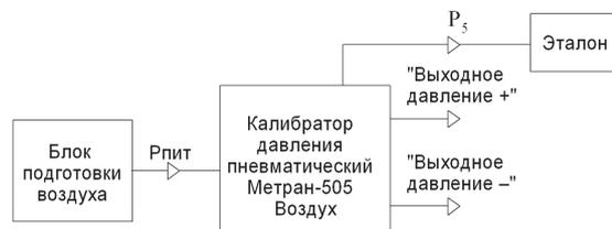
Рисунок 1 – Схема подключения при измерении контрольного давления  $P_5$
