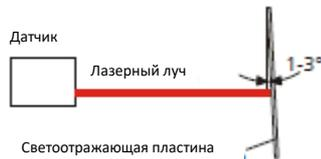
Рис. 23. Монтаж отражательных пластин
