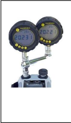
Для достижения более высокой эффективности возможно подключение двух поверяемых приборов одновременно. Переходник подключается к порту давления DPI611 и обеспечивает два выходных порта. Совместим с поставляемыми стандартными переходниками и наборами переходников.
