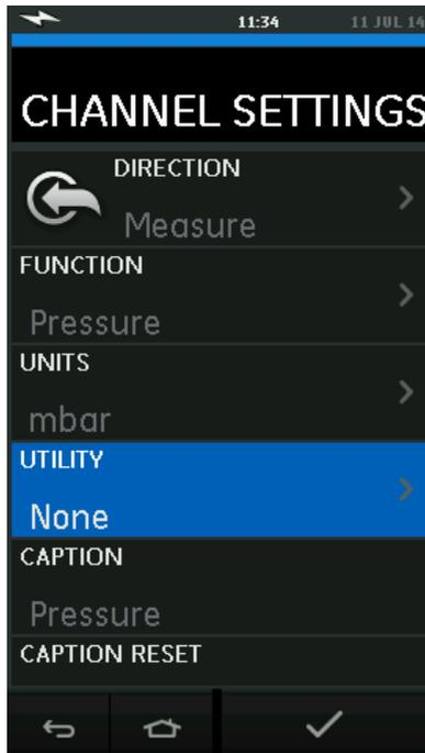
Рисунок 2-19 Меню Настройки канала (Channel Settings)
