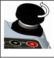
Чтобы сбросить давление в данном приборе, поверните выпускной клапан давления против часовой стрелки (1 оборот).
