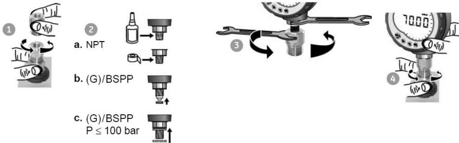
**Рисунок 2-2 Подсоединение / отсоединение приборов давления****Таблица 2-1**
