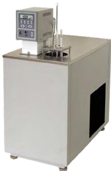
Жидкостные термостаты - это наиболее оптимальное решение для стационарной лаборатории в области поверки термопреобразователей сопротивления (ГОСТ 8.461-2009), манометрических термометров (ГОСТ 8.305-78), а также стеклянных жидкостных (ГОСТ 8.279-78) и ртутных термометров (ГОСТ 8.317-78).
