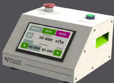
Интерфейсный модуль предназначен для управления гидравлическим контроллером в ручном или полуавтоматическом режимах. Для этого в интерфейсный модуль встроен емкостной сенсорный экран, с помощью которого пользователь задает требуемое давление и единицы измерения. В полуавтоматическом режиме контроллер последовательно проходит через ряд точек, заданных пользователем.
