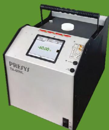
С помощью жидкостной вставки со встроенной мешалкой можно превратить сухоблочный калибратор в небольшой термостат для достижения более высоких показателей неоднородности и нестабильности, необходимых для поверки термометров сопротивления класса А и выше.
