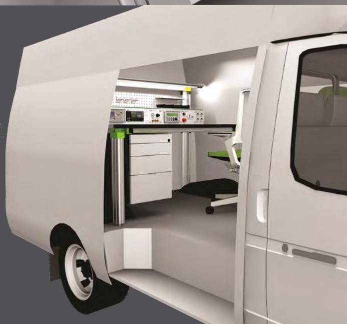
В лабораторном отсеке находится метрологическое оборудование, необходимое для проведения поверочных работ.
