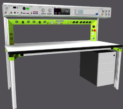
Стенд поверки датчиков давления и манометров предназначен для поверки и калибровки:
