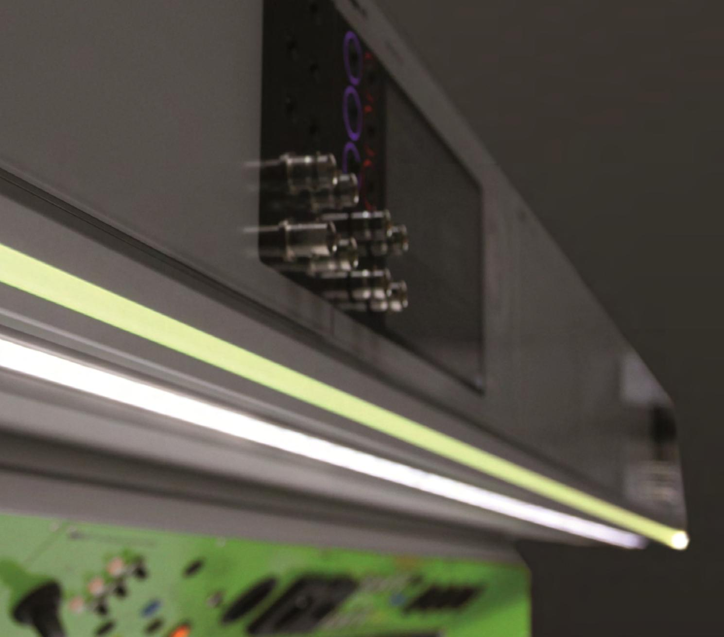
Освещение стендов эрфи спроектировано так, что не требует дополнительного пространства для установки. В нижнем профиле кокпита расположен специальный светильник. Он обеспечивает оптимальное равномерное бестеневое освещение рабочей поверхности, что имеет большое значение в работе метролога.
