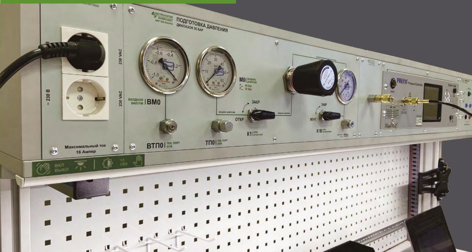
Кокпит выпускается в двух вариантах по высоте: 3U (130мм) и 6U (260мм), а также в трех вариантах по глубине: 260 мм, 360 мм и 500 мм. Приборный кокпит может располагаться параллельно столешнице или наклонно под углом в 10° для более удобного доступа к оборудованию. Благодаря этим опциям возможна установка практически любого прецизионного или пневматического оборудования, а рабочему персоналу работать за стендом станет комфортнее.
