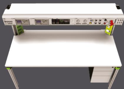
Стенд поверки датчиков температуры предназначен для поверки и калибровки датчиков температур:
