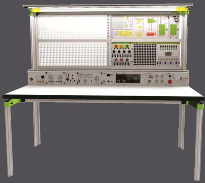
В испытательные стенды с помощью системы направляющих устанавливаются обучающие модули, которые легко заменяются в зависимости от темы лабораторной работы.
