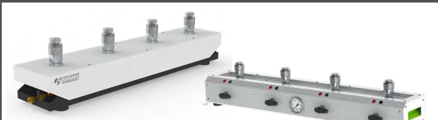
Подключение поверяемых средств измерения давления осуществляется с помощью коллекторов, которые позволяют одновременно устанавливать до 5ти поверяемых устройств. Для присоединения прибора используется быстрозажимной порт с резьбой М20х1.5 (возможно изготовление порта с другим типом резьбы). За счет внутренних уплотнений затяжка резьбы производится от руки без использования гаечных ключей.
