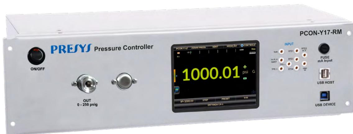
Контроллер давления - это ядро любого автоматизированного стенда поверки средств измерения давления. Он предназначен для автоматического измерения, задания и регулирования давления с высокой точностью и стабильностью. Принцип работы контроллера давления основан на функционировании системы клапанов внутри прибора, высокая скорость работы которых позволяет прибору выходить на заданную точку в течение нескольких секунд.
