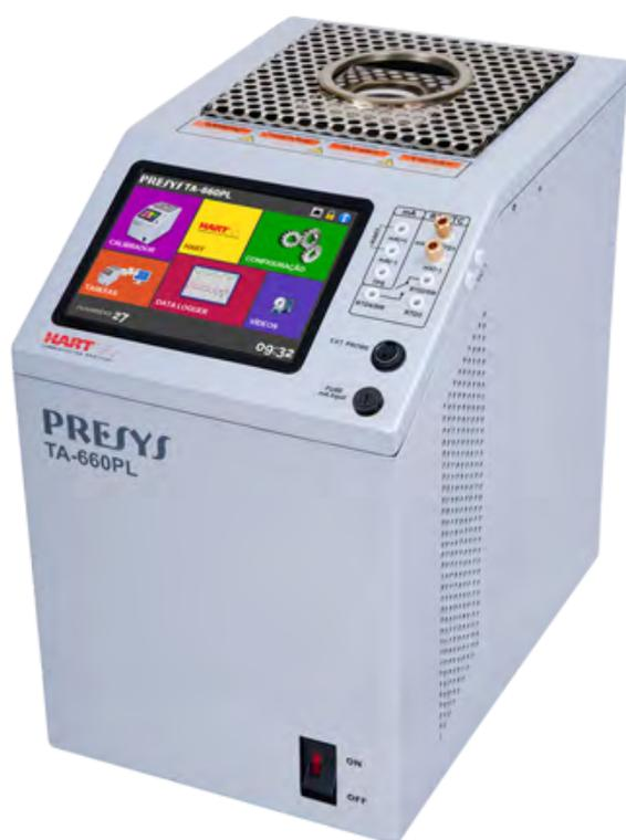
Сухоблочные калибраторы являются компактным решением для калибровки и поверки термометров сопротивления, термопар, а также преобразователей температуры с унифицированным выходным сигналом. Небольшой вес, габариты, а также высокая скорость работы по сравнению с жидкостными термостатами и высокотемпературными печами делают сухоблочные калибраторы идеальным решением для мобильных лабораторий, работы в полевых условиях, особенно в период проведения пуско-наладочных и ремонтных работ.
