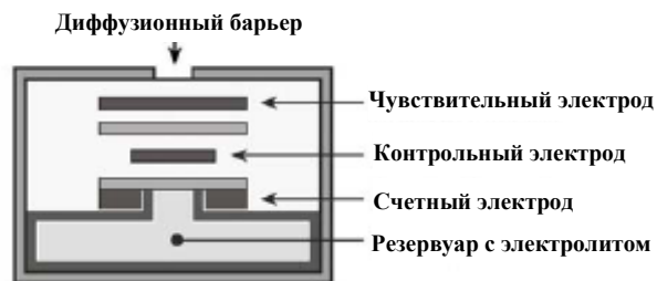
Рисунок 1 Устройство электрохимического датчика токсичных газов
